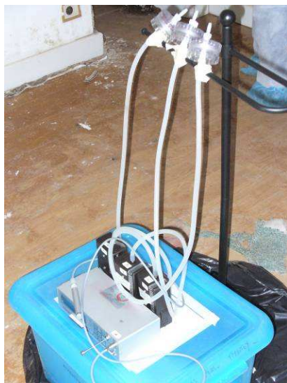
Photos 1 et 2 (D. Garon). Collecte de bioaérosols au moyen de pompes portatives, compteur à particules et biocollecteur Coriolis® µ.
