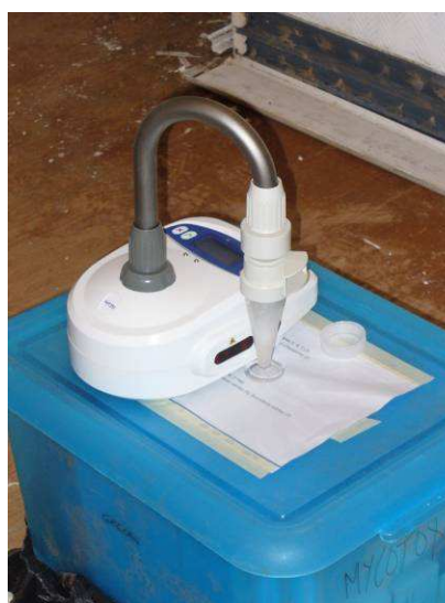
Photos 1 et 2 (D. Garon). Collecte de bioaérosols au moyen de pompes portatives, compteur à particules et biocollecteur Coriolis® µ.
